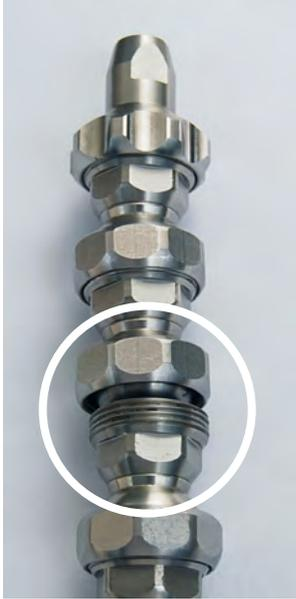
⑤つぎにナットを締め付けていく場合、③の操作とは逆方向にレンチを動かすと固定されます。
