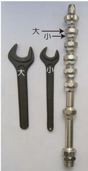
②大・小の専用レンチをジョイントホースのナット部分に挿入します。
