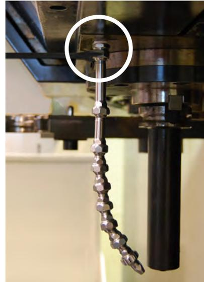
⑤最後にノズルの向きを調整して下さい。
